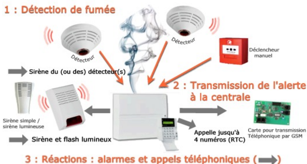
Principe de Fonctionnement de l'Alarme Incendie
